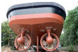
Doppelschraubenantrieb mit Mantelpropellern (Kort-Düsen)
