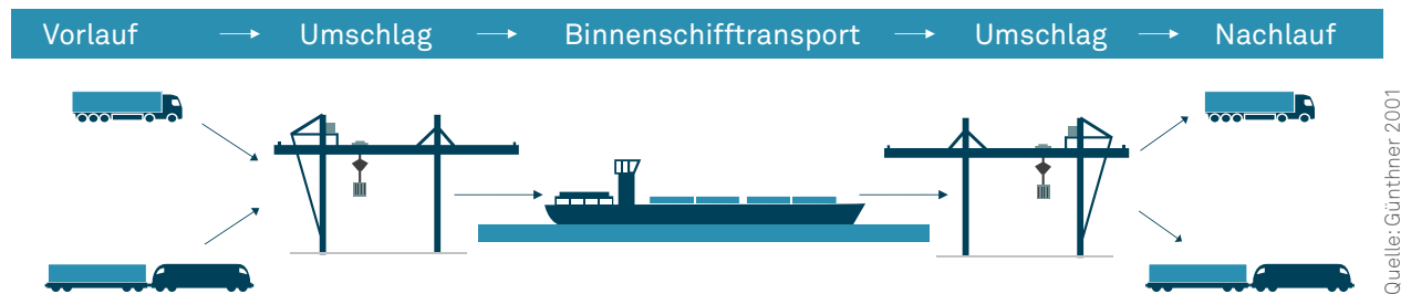
Intermodaler beziehungsweise kombinierter Verkehr am Beispiel eines Containertransportes
