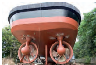
Doppelschraubenantrieb mit Mantelpropellern (Kort-Düsen)
