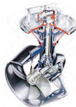
SCHOTTEL Ruderpropeller (Z-Antrieb)
