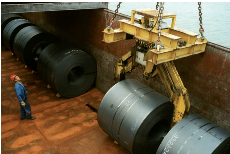
Umschlag von Stahlcoils
