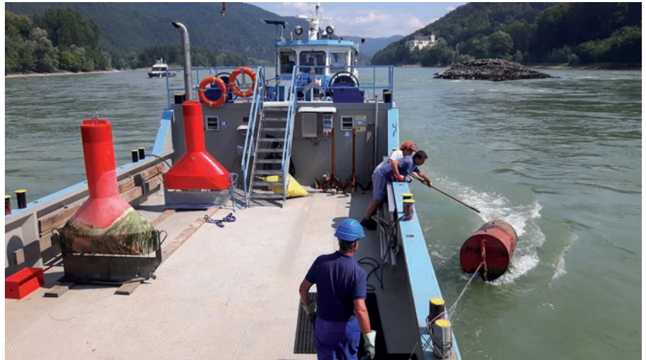
Manipulation einer roten Tonne zur Bezeichnung des rechten Fahrwasserrandes auf der österr. Donaustrecke
