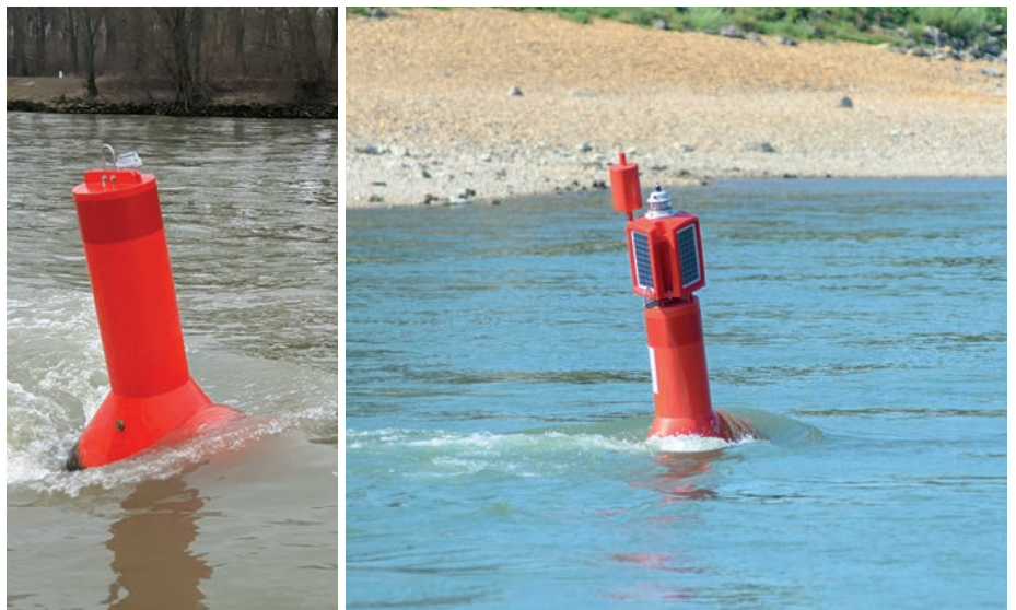
Einsatz von Fernüberwachungstechnologien auf Kunststofftonnen des Typs B7 (unbeleuchtet) und LT B7 (beleuchtet); links: Monitoring über Globalstar (Satellit), rechts: Monitoring über AIS
