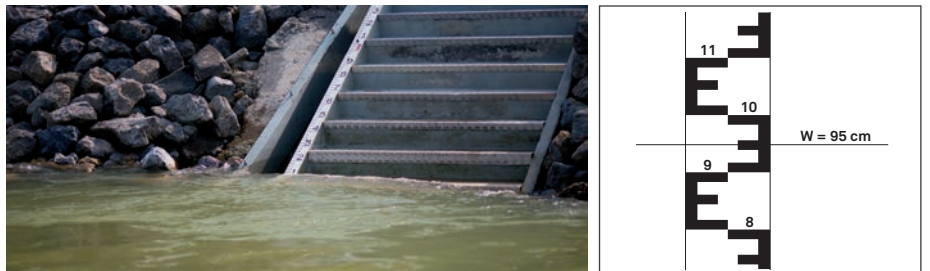
Pegellatte an einer Pegelmessstelle; beispielhafter Wasserstand am Pegel von 95 cm
